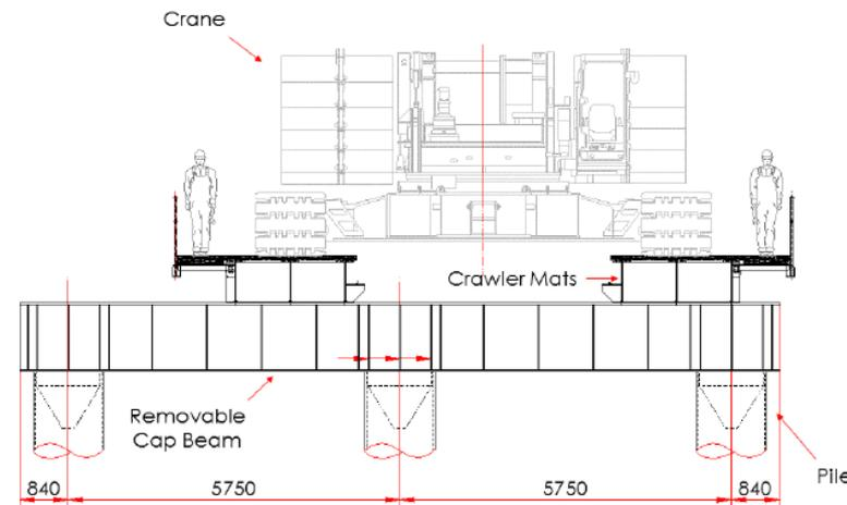
*Elevación – Módulos de montaje*
